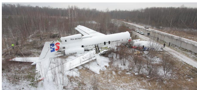
Rys. 5. Katastrofa Tu-154M w Moskwie w dniu 4.12.2010. Katastrofa typu 1A – samolot uderzył w ziemię i nie było eksplozji.
