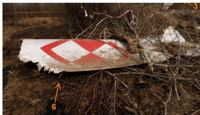
Rys. 25. Fragment pokrycia dolnej powierzchni końcówki lewego skrzydła z fragmentem owiewki prowadnicy klap (6), w tle prawy statecznik poziomy (3) [17]. Górna poszycie zostało rozdrobnione i jego kawałki leżą w odległych miejscach.
