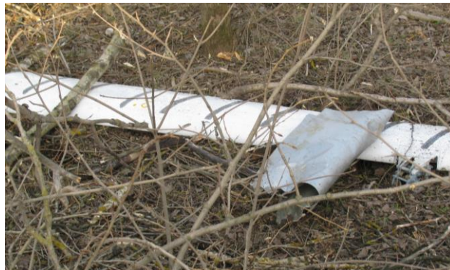
Rys. 20. Interceptor (deflektor) skrzydła lewego leżący w lesie około 10 m od ul. Kutuzowa. Na wierzchu leży fragment slotu. Zdjęcie wykonane przez Jana Gruszyńskiego.
