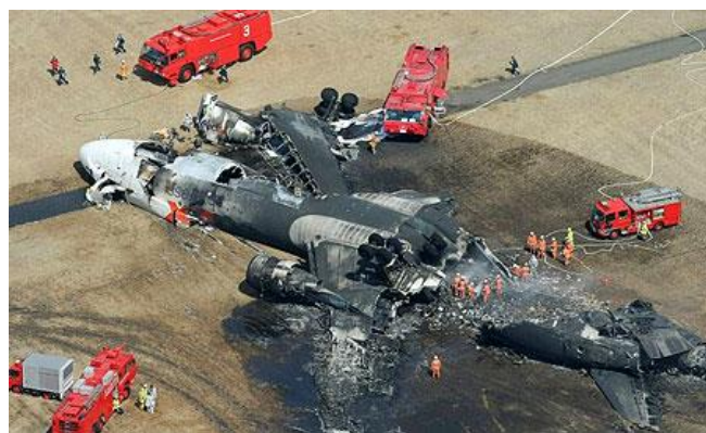
Rys. 9. Katastrofa MD-11 w Tokio w dniu 23.03.2009. Katastrofa typu 1B – samolot uderzył w ziemię i pękł na kilka części prostopadle do osi. Następnie wybuch rozerwał tylną część – została rozerwana i rozwarła się wzdłuż osi.
