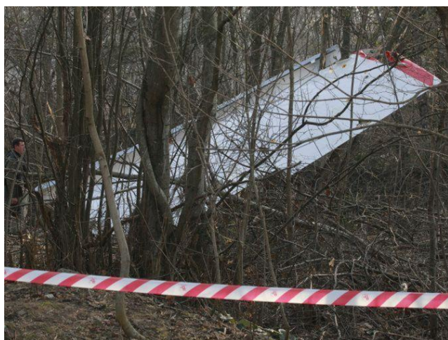
Rys. 29. Końcówka lewego skrzydła leżąca w miejscu otoczonym ze wszystkich stron drzewami o wysokości powyżej 10 m [19].
