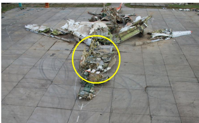
Rys. 4. Wrak Tu 154 leżący na lotnisku w Smoleńsku [6]. Nawet po odcięciu sufitu i dużej części burt jest oczywiste, że kadłub został rozerwany, a nie zgnieciony.
