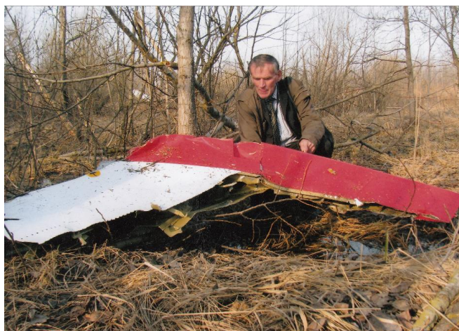
Rys. 18. Fragment lewego statecznika poziomego leżący w lesie około 5 m od ul. Kutuzowa. W tle za drzewami widać całą lotkę. Foto Jan Gruszyński. Deformacja oderwanej części wyklucza, aby oderwanie nastąpiło na skutek uderzenia w przeszkodę terenową.
