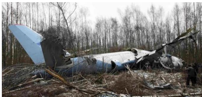
Rys. 6. Katastrofa TU-204 w Moskwie w dniu 22.03.2010. Katastrofa typu 1A – samolot uderzył w ziemię i nie było eksplozji.
