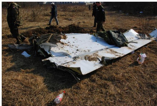
Rys. 21. Tylna część lewego statecznika poziomego z lewym sterem wysokości leżąca w strefie B5 [17].
