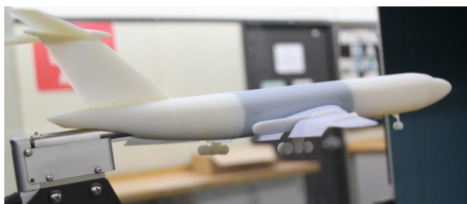
Rys. 7. Modele samolotu w konfiguracji „Cruise” i „Landing” w tunelu aerodynamicznym podcpeione do sensora pomiarów sił i momentów „Stin Balance”.
