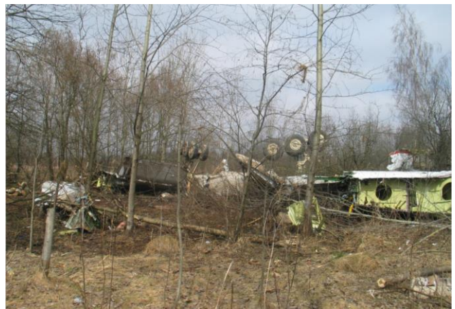
Rys. 38. Strefa B8. Środkowa część strefy z leżącymi podwoziami i częściami cetroplata.
