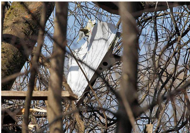
Rys. 40. „Blaszane ptaki” wiszące na drzewach są niepodważalnym dowodem na to, że oderwały się od samolotu kilkadziesiąt metrów wcześniej i kilkadziesiąt metrów wyżej.
