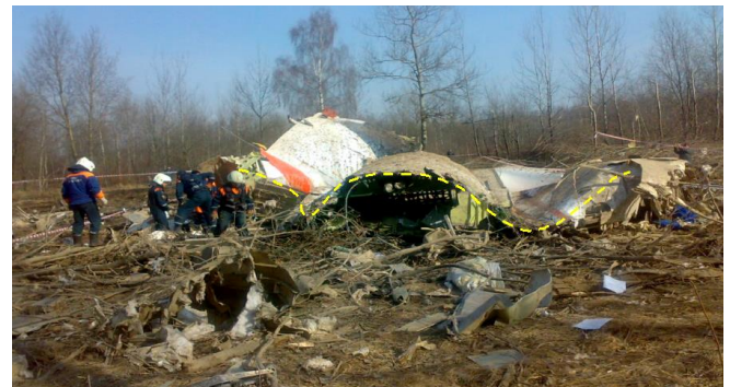
Rys. 27. Deformacja kadłuba Tu-154 w Katastrofie Smoleńskiej. Dowód, że otwarcie kadłuba nastąpiło na wysokości większej niż długość wywiniętych jego części.
