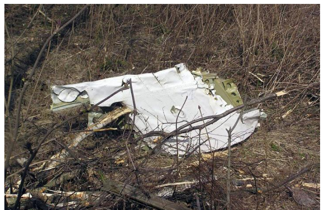
Rys. 32. Strefa B3. Duży fragment poszycia środkowej części skrzydła lewego.
