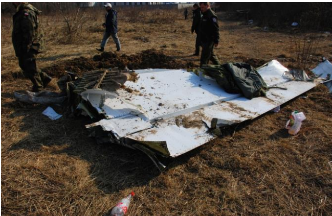
Rys. 34. Strefa B5. Część lewego statecznika poziomego i steru wysokości.
