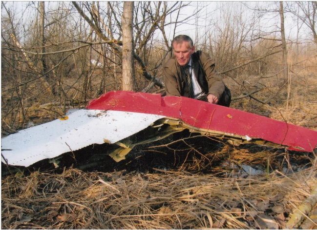
Rys. 33. Strefa B4. Część lewego steru wysokości
