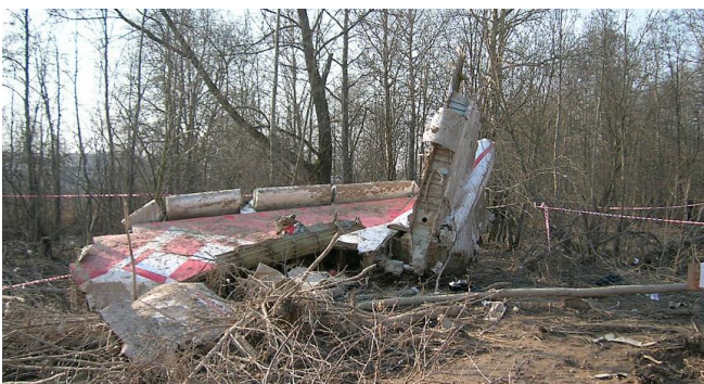
Rys. 36. Strefa B7. Statecznik pionowy z resztkami steru kierunku i stateczników poziomych.
