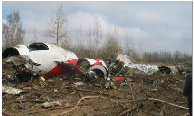
Rys. 37. Strefa B8. Wschodnia część strefy. Na pierwszym planie część ogonowa (silnikowa), dalej widoczny rozerwany i leżący dnem do góry kadłub.
