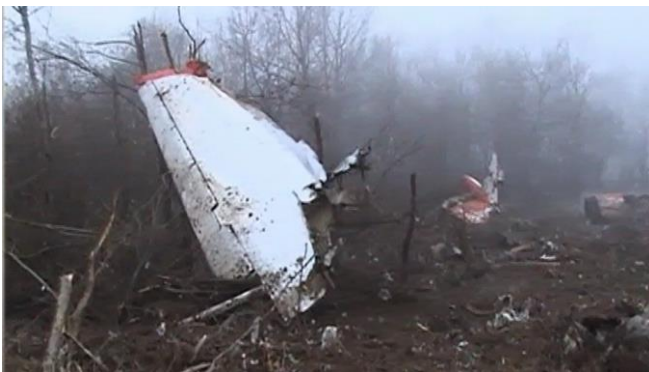
Rys. 35. Strefa B6. Końcowa część prawego statecznika poziomego ze sterem wysokości.
