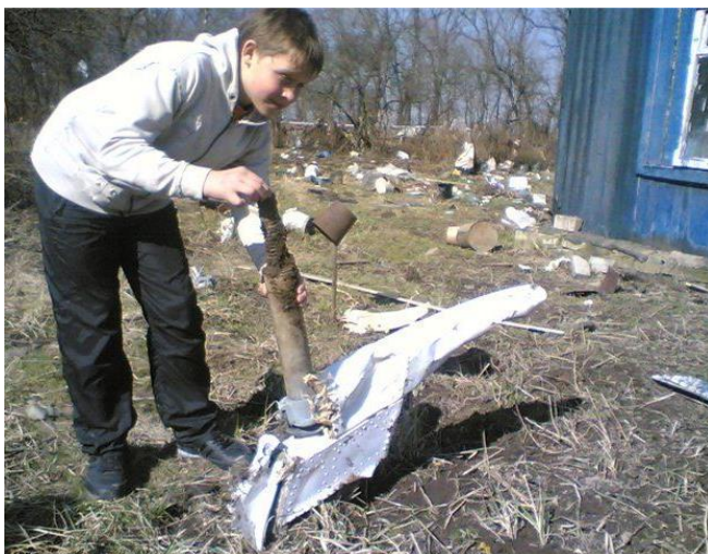
Rys. 30. Strefa B1. Napęd interceptora lewego skrzydła. Lokalizacja w konstrukcji skrzydła wyklucza możliwość oderwania w wyniku uderzenia o zewnętrzną przeszkodę.
