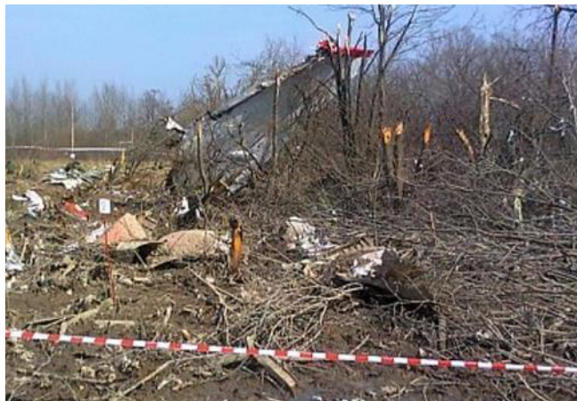
Rys. 8. Sektor nr 12 prawy statecznik poziomy samolotu. Ostatni duży element na wrakowisku leżący przy południowo wschodniej granicy sektora 12. Punkt dowiązania pomiarów w strefie 12 Fot. Internet.
