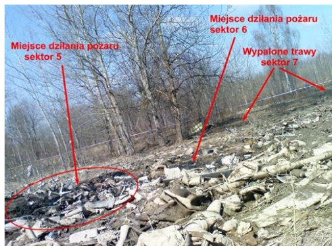
Rys. 17. Strefa intensywnego pożaru na wrakowisku obejmująca część sektora 6 oraz spalona trawa na części sektora 7. Fot. Internet.
