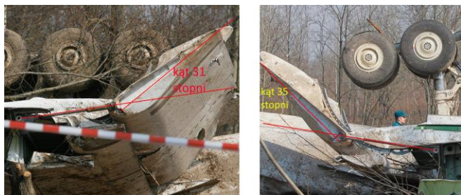
Rys. 9. Porównanie orientacyjne różnicy kątów wychylenia lewej i prawej kłapy.
