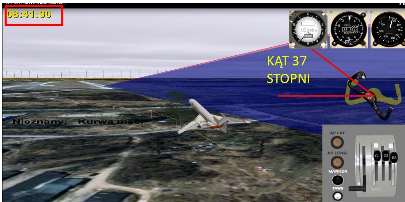
Rys. 17. Kadr z wizualizacji KBWL[9], przedstawiający wolant obrócony o kąt ok. 37 stopni jeszcze przed hipotetycznym uderzeniem w brzozę.
