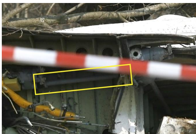
Rys. 14. Wygląd nieuszkodzonego połączenia wału przeniesienia napędu lewej kłapy (zaznaczenie żółtym prostokątem)
