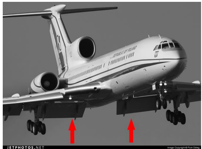
Rys. 1. Samolot Tu154M w konfiguracji do lądowania. Zaznaczone obie klapy na centroplacie. Autor Piotr Obieg [2.]
