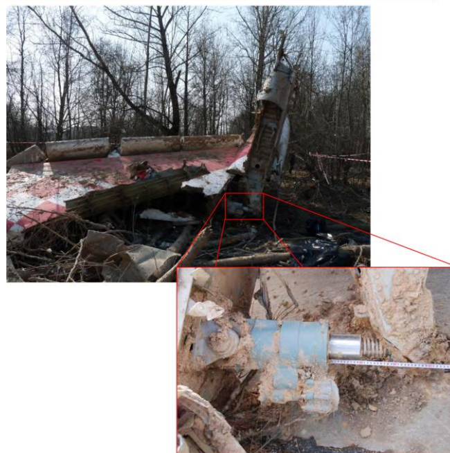
Rys. 14. Statecznik poziomy ustawiony na kąt -3^\circ
