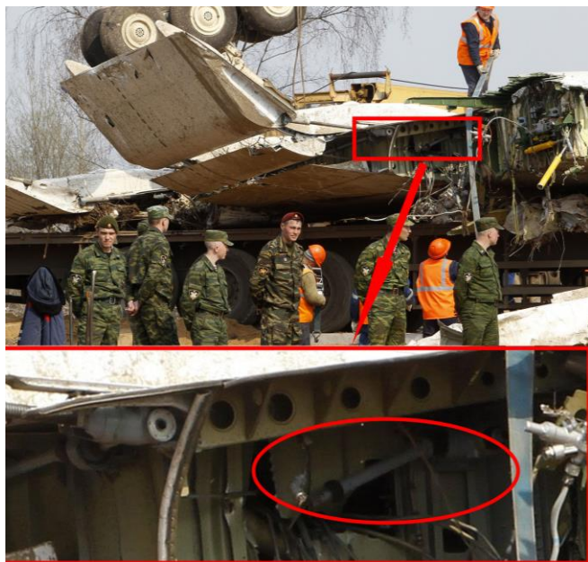
Rys. 13. Wygląd wału napędowego prawej kłapy. Widoczne przerwanie połączenia wału napędowego z przekładnią mechaniczną.
