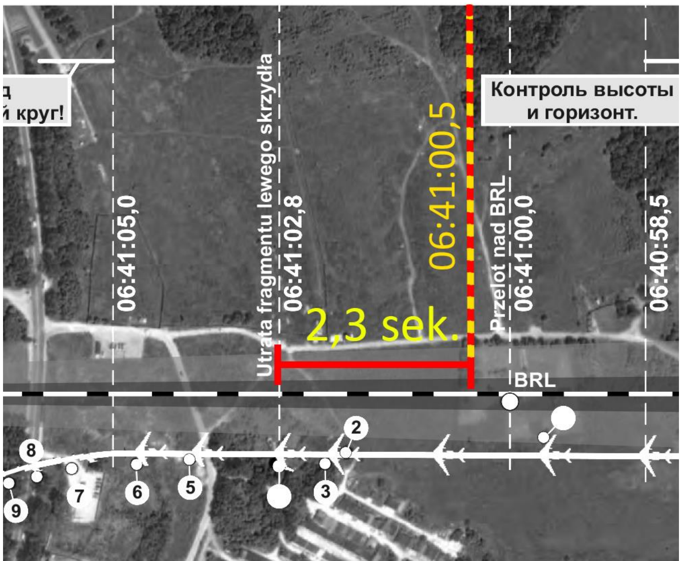
Rys. 16. Rysunek z załącznika do raportu KBWL, na który naniesiono odcinek czasowy pomiędzy momentem obrotu wolantu o kąt większy niż 30 stopni (czerwona, pozioma linia), oraz miejsce w którym nastąpił obrót wolantu przekraczający ten kąt (pionowa, żółto czerwona linia). Jest to miejsce tuż za bliższą radiolaternią. Obrót wolantu może wskazywać na próbę korekty przechylenia samolotu spowodowanego rozsynchronizowaniem kłap.
