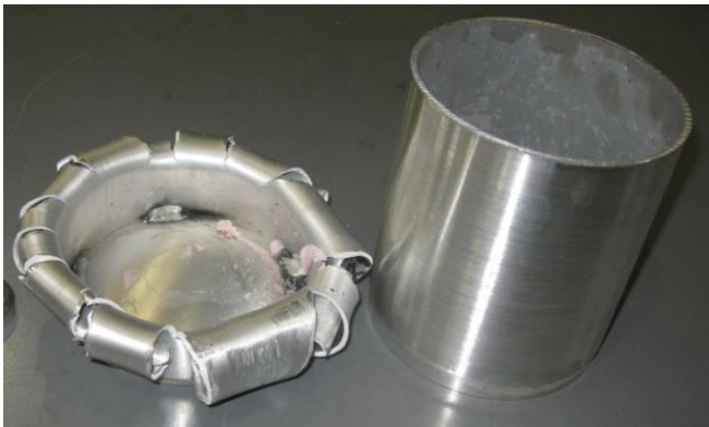
Rys. 16. Eksperymentalny rezultat zniszczenia sabotu dla prędkości 300 m/s.
