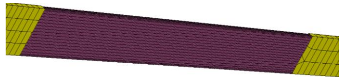
Rys. 17. Siatka małych elementów trójwymiarowych modelujących fragment pierwszego dźwigara w obszarze kontaktu z brzozą.
