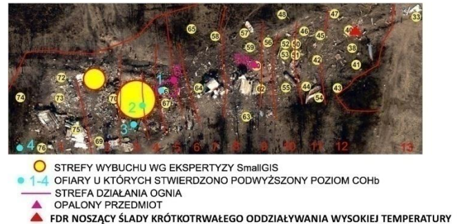
Rys. 11. Przedmioty noszące ślady wysokiej temperatury poza strefami działania ognia na wrakowisku
