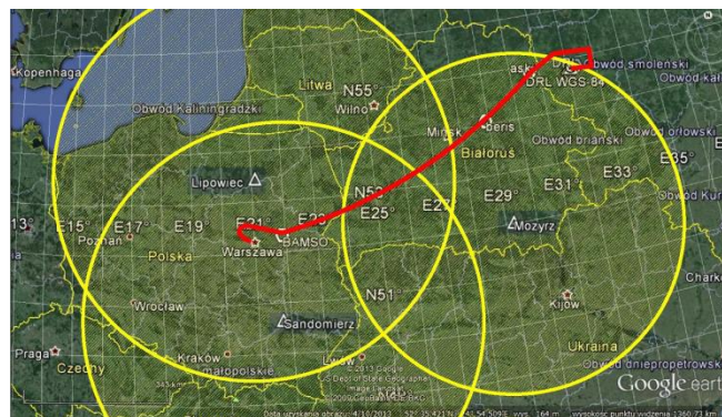
Rys. 12. Trasa lotu Tu-154 M „101” w dniu 10.04.2010 roku i zasięg wojskowych stacji radarowych w Lipowcu, Sandomierzu i Mozyrz. Na rysunku nie uwzględniono stacji radarowych FR (brak danych).
