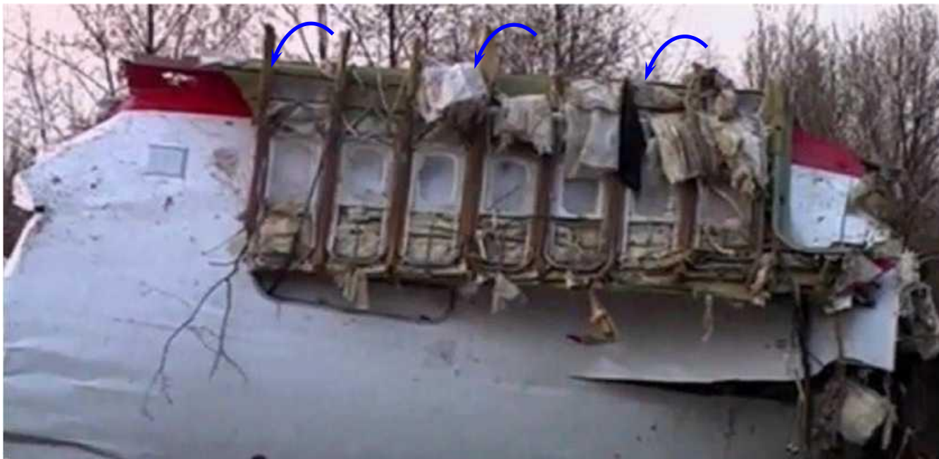
Rys. 17. Część pasażerska kadłuba samolotu TU-154M rozerwana wzdłuż osi podłużnej, zdjęcie por. Szuladziński [6].
