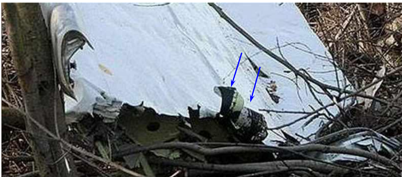
Rys. 18. Charakterystyczne płatki blachy na przelomie odcinka skrzydła, który odpadł od samolotu TU-154M, por. [5].
