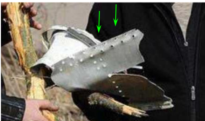
Rys. 19. Ślady równomiernego wyrwania nitów w kierunku prostopadłym do poszycia, wskazują że zniszczenie tego fragmentu skrzydła nastąpiło na skutek działania ciśnienia wewnętrznego wytworzonego wewnątrz profilu skrzydła, zdjęcie por. Raport Zespołu Parlamentarnego [5].
