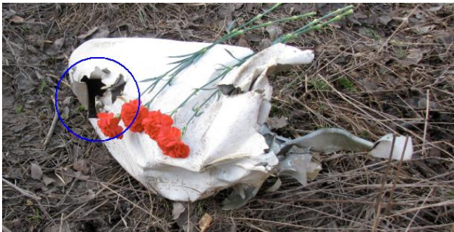
Rys. 64. Owiewka skrzydła leżąca w strefie 4. Otwór z wywinietymi na zewnątrz brzegami stanowi dowód rozerwania od środka. Foto Jan Gruszyński.
