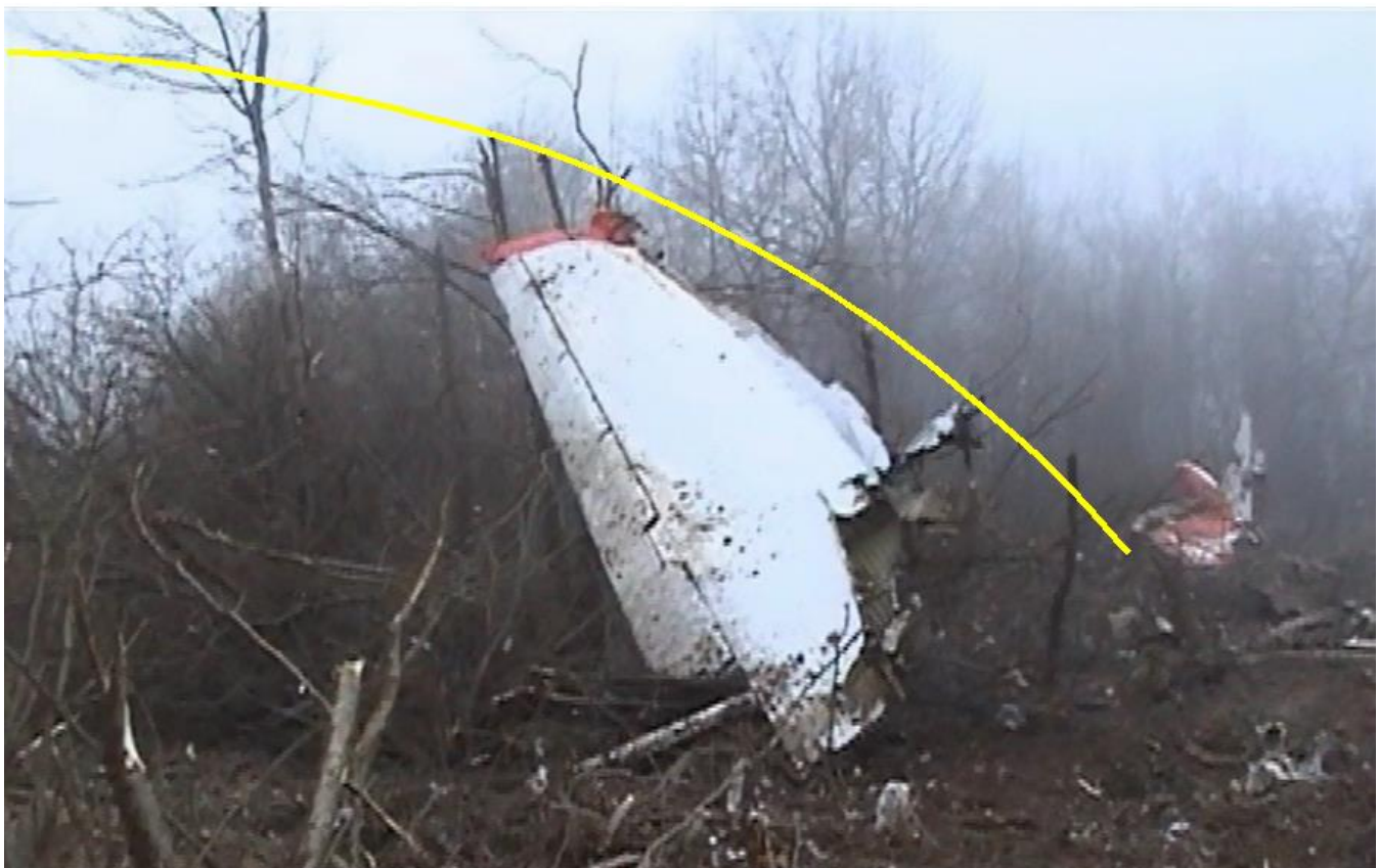
Rys. 56. Zadrzewienie na trasie upadku statecznika pionowego. Na pierwszym planie prawy statecznik poziomy z lotką. Widoczne za nim wierzchołki ulamanych drzew wskazują trajektorię statecznika pionowego. Kadr z filmu wykonanego przez Sławomira Wiśniewskiego.
