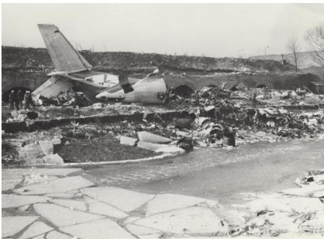
Rys. 10. Miejsce katastrofy samolotu Ił-62 „Kopernik”. Samolot przebił lód i uderzył w zbocze fosi pod kątem zbliżonym do 90 stopni [21].
