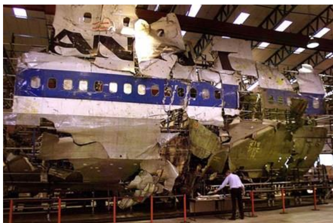
Rys. 19. W hangarze na specjalnie wykonanym stelażu mocuje się kolejne szczątki odtwarzając całą konstrukcję samolotu. [37].
