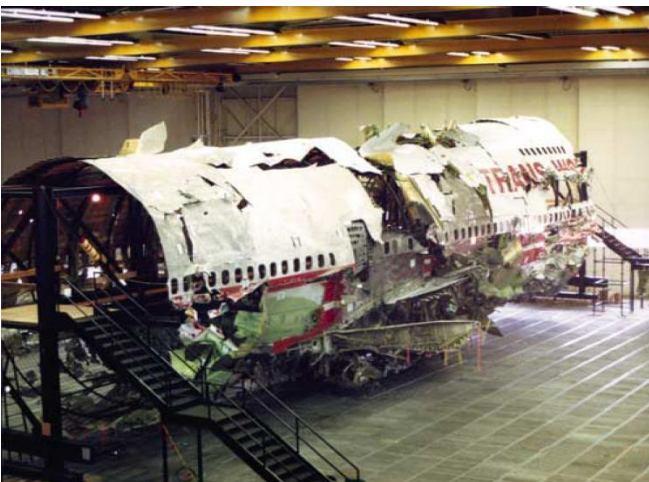
Rys. 22. Rekonstrukcja wraku samolotu TWA w hali ze szczątków wydobytych z dna oceanu [40].
