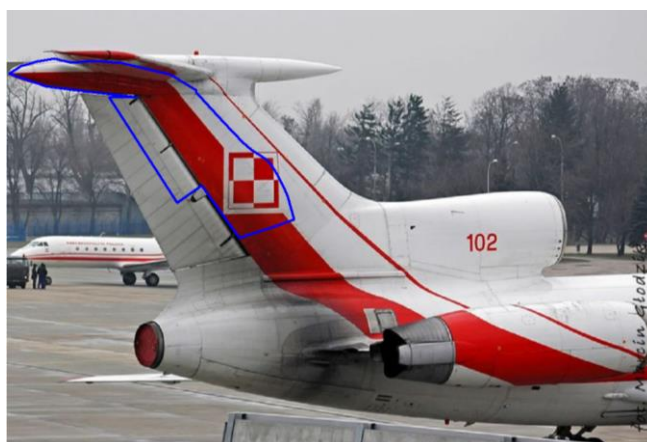
Rys. 50. Część usterzenia leżąca na wrakowisku w Smoleńsku zaznaczona jest na zdjęciu niebieską linią. Wykorzystano foto Marcin Głodzik [64].
