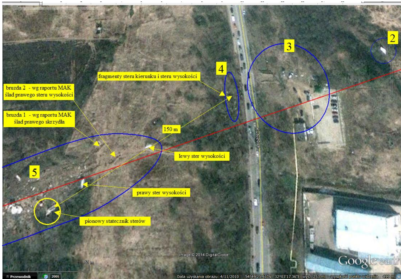
Rys. 57. Położenie statecznika pionowego i fragmentów steru kierunku i wysokości. Odległość między tymi elementami sięga 150 m.
