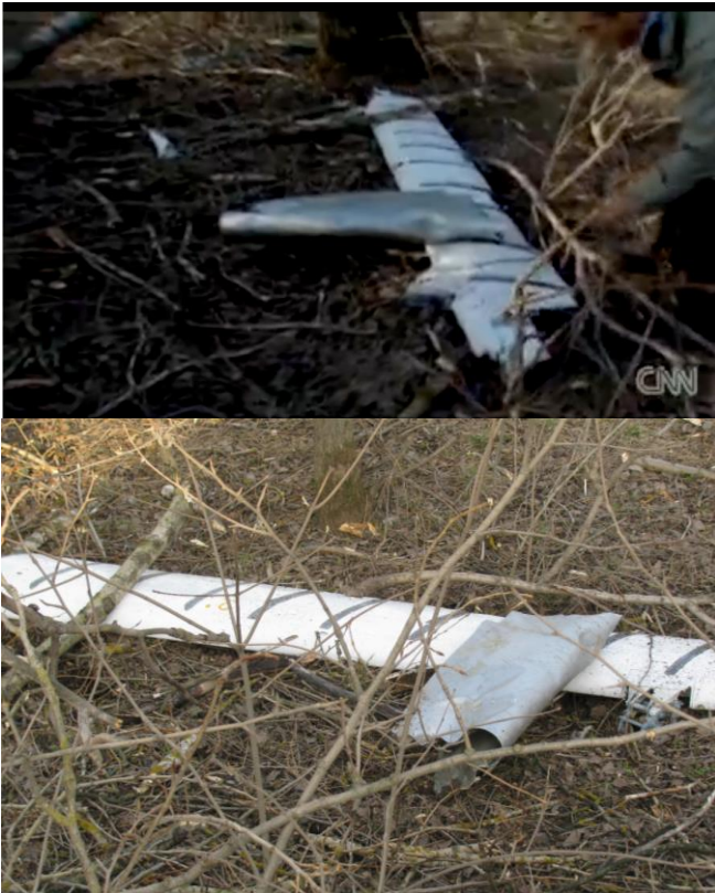
Rys. 52. Fragment steru kierunku wraz z elementami napędu leżący w lesie około 10 m od ul. Kutuzowa. Na wierzchu leży fragment poszycia samolotu. Zdjęcie górne - kadr z filmu CNN [63]. Zdjęcie dolne wykonane przez Jana Gruszyńskiego.
