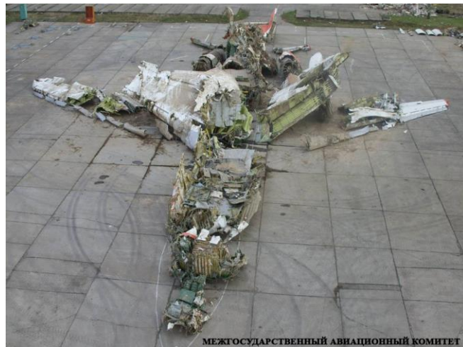
Rys. 61. Postać zniszczenia samolotu Tu-154 w Katastrofie Smoleńskiej. Wrak samolotu leżący na lotnisku w Smoleńsku.
