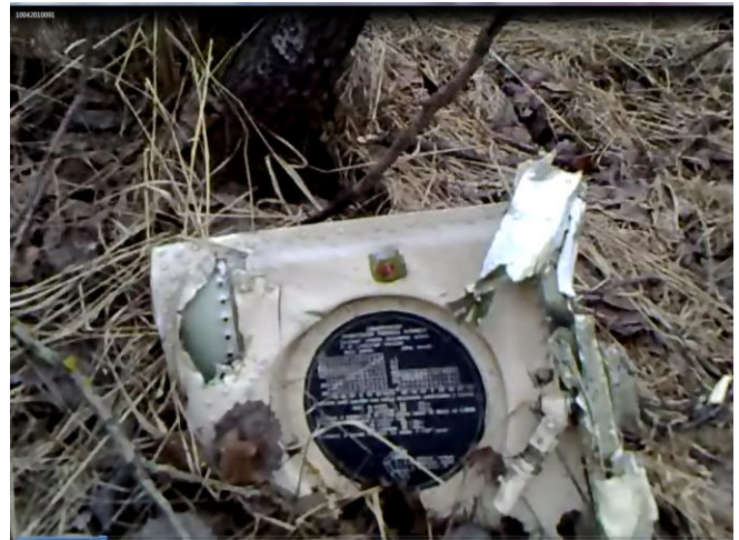
Rys. 54. Fragment amortyzatora podwozia głównego leżący między drzewami w strefie 4.
