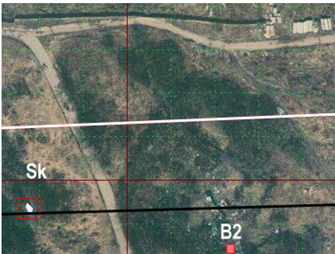
Rys. 7. W czerwonym prostokącie urwana końcówka lewego skrzydła. Jej długość jest porównywalna z szerokością drogi znajdującej się w górnej części zdjęcia, a więc jest tego samego rzędu co szerokość czerwonej linii na Rys. 6. Stąd wniosek, iż w ekspertyzie ATM trajektorię przesunięto w stronę brzozy (punkt B2) na odległość rzędu długości urwanej końcówki skrzydła.
