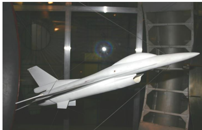
Rys. 16. Model samolotu F-16 w tunelu aerodynamicznym.
