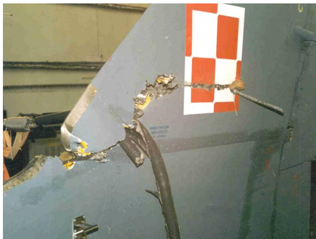
Rys. 20. Statecznik pionowy samolotu MiG-29 z powstałymi uszkodzeniami na skutek awaryjnego lądowania.
