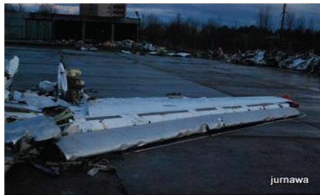
Rys. 10. Lewe skrzydło z niezniszczoną krawędzią przednią [13].
