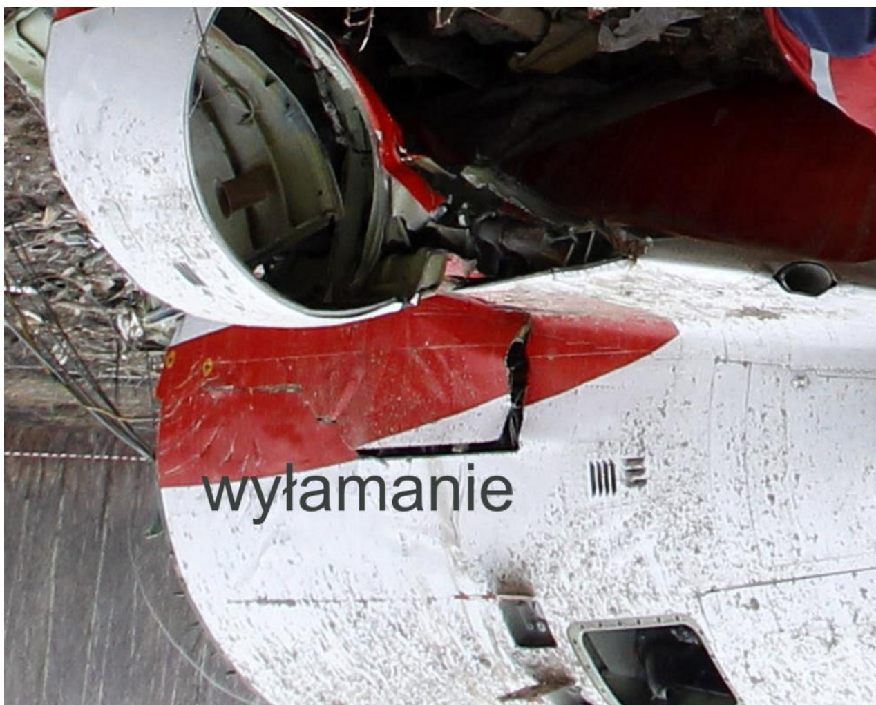
Rys. 22. Na zdjęciu [8] nie widać śladów uderzenia obudową lewego silnika o grunt, a wylamanie w pozycji wskazuje na siłę wylamującą działającą od dołu. Innym sposobem wylamania może być efekt bezwładności silnika przy gwałtownym przechyleniu kadłuba na tę stronę.
