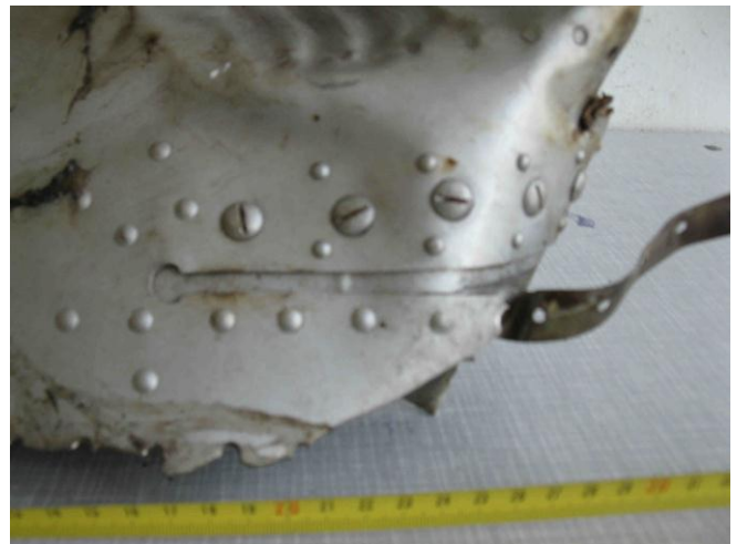
Rys. 35. Widoczne: reparacja poszycia z licznymi nitami i śrubami; zgniecenie w płaszczyźnie poszycia – pofalowania blachy grubości 1,22 mm. Z prawej niewielki płaskownik o grubości 0,55 mm. Kolor srebrny.
