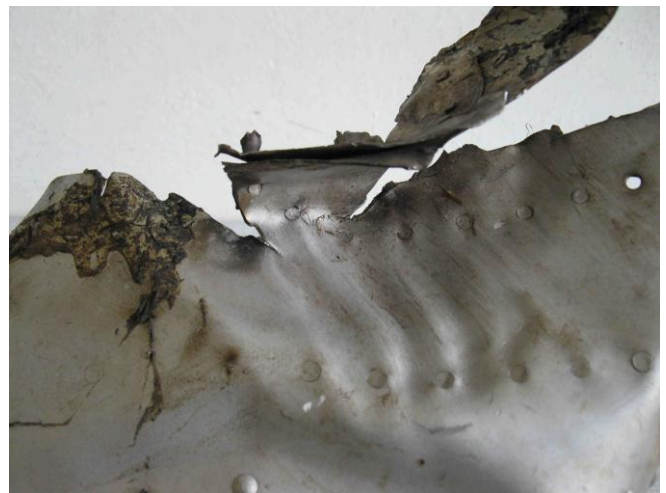
Rys. 36. Zdjęcie nawiązuje do Fotogramu 5A i zdjęcia z Rys. 33. Widoczne zgniecenia w płaszczyźnie poszycia – pofalowania blachy grubości 1,22 mm. U góry oddarty i nienaturalnie odgięty fragment blachy poszycia. Kolor srebrny
