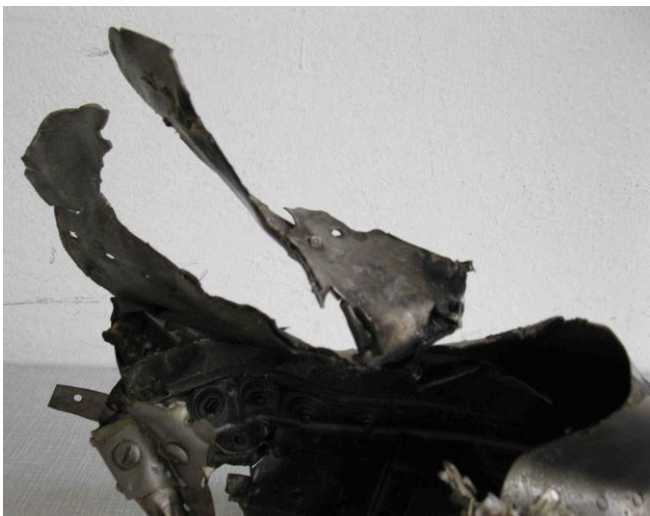
Rys. 38. Postrzępione – porozrywane krawędzie blach.
