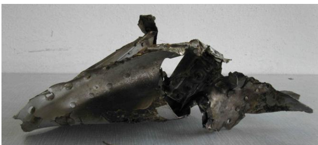
Rys. 15. Ujęcie nawiązuje do Fotogramu 2A. Widać, że badany element jest fragmentem owiewki mocowanej do poszycia samolotu. Tu z zewnątrz osmalenia i duże ubytki powłoki.
