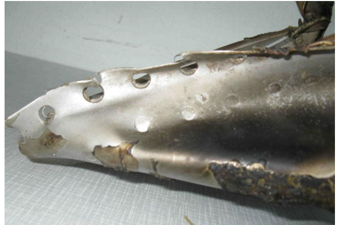
Rys. 16. Powiększenie nawiązuje do Fotogramu 7A i Rys. 15. Widoczne zniszczenia powłoki zewnętrznej elementu malarskiej lub zabezpieczającej. Widać przebarwienia termiczne i duże ubytki powłoki ochronnej blach.
