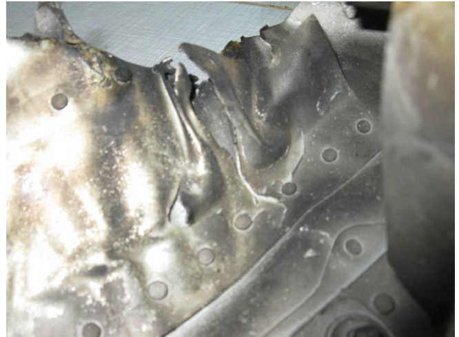
Rys. 40. Widoczne zgniecenia w płaszczyźnie poszycia – pofalowania blachy grubości 1,22 mm. Osmalenia.
