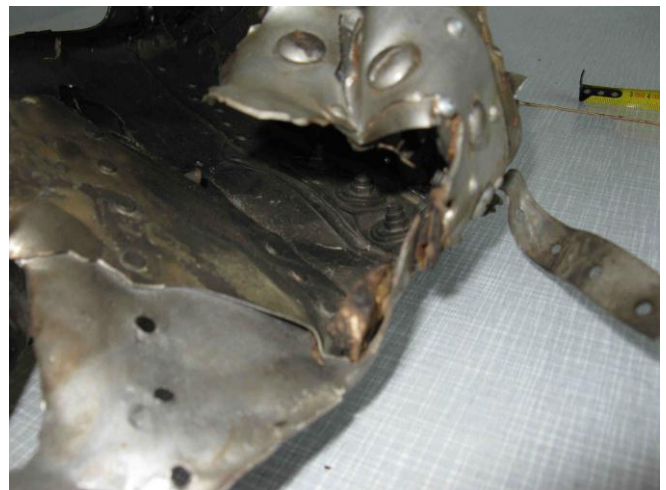
Rys. 42. Zbliżenie i/lub inne ujęcie rysunków Rys. 39, Rys. 46 i Rys. 47. Wnętrze osmalone. Na zewnątrz kolor srebrny.
