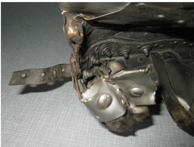
Rys. 39. Zwraca uwagę, na lewej urwanej krawędzi brązowego koloru tektura jako przekładka. W dotyku materiał bardzo miękki.
