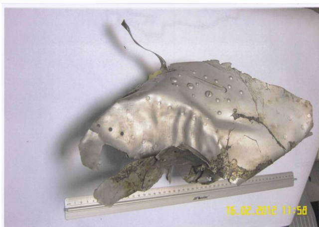
Rys. 5. Fotograf 5A. Kolejne ujęcie. Widoczne zgniecenia w płaszczyźnie poszycia – pofalowania blachy grubości 1,22 mm. Kolor srebrny. Ubytki i pęknięcia (rozerwania) powłoki zewnętrznej blach.
