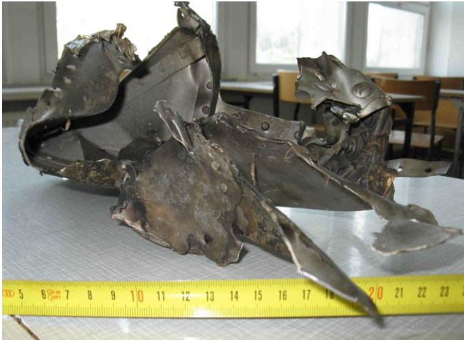
Rys. 13. Zdjęcie wykonane poziomo od strony „lewej” ku „przodowi”. Widoczne rozerwanie i odchylenie poszycia od zebra – po lewej u góry.
