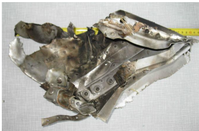
Rys. 8. Ujęcie „z góry” – widok od środka elementu. Zdjęcie nawiązuje do Fotografamów 3A, 4A i 8A. Rozerwanie i silne rozchylenie połączonych krawędzi. Osmaleni i kolor srebrny.
