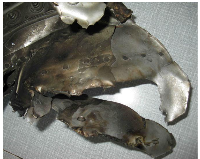
Rys. 24. Zdjęcie nawiązuje do Fotogramów 4A i 8A – widoczne tam po lewej stronie postrzępione wydłużone blach poszycia.
