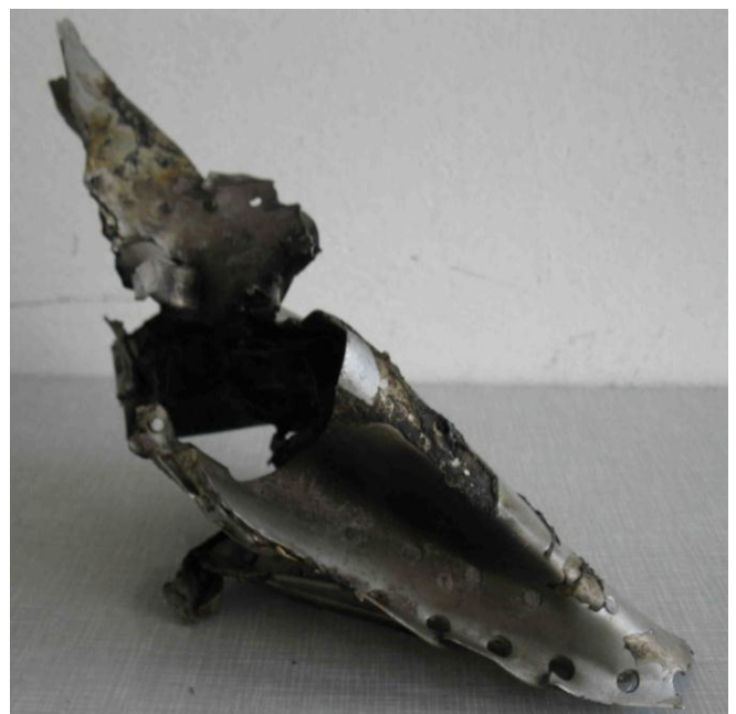
Rys. 17. Ujęcie pod innym kątem elementu widocznego na Rys. 15. Zdjęcie pokazuje wyraźnie, że jest to profilowany fragment osłony aerodynamicznej mocowanej do poszycia np. skrzydła. Został z niego wyrwany.
