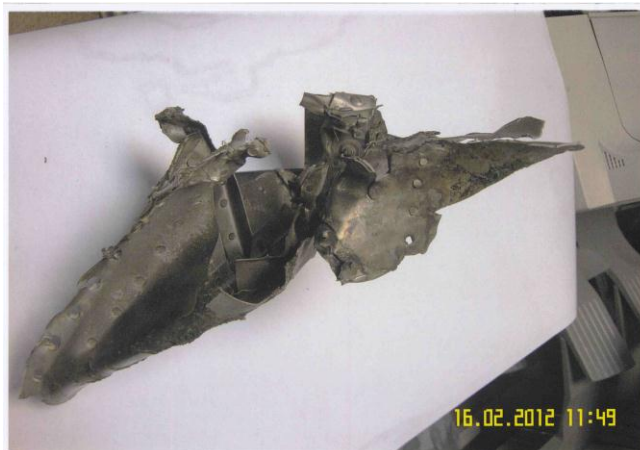
Rys. 6. Fotograf 7A. Zdjęcie jednoznacznie przedstawia ten sam element, co na rysunkach 3, 4 i 7, lecz jest wykonane z boku – z prawej strony. Widoczne osmalenie owiewki i wnętrza elementu.
