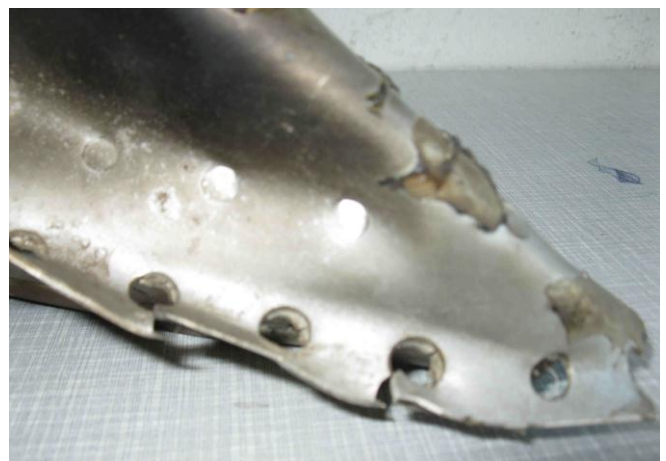
Rys. 18. Zbliżenie nawiązuje do zdjęcia z Rys. 15, Rys. 16 i Rys. 17. Widać uszkodzenia powłoki blach i przebarwienia termiczne. Otwory na nity porozrywane. Końcówka srebrna.
