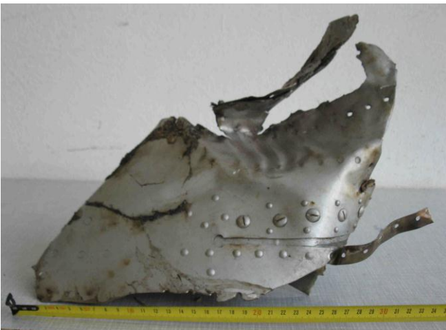
Rys. 33. Zdjęcie nawiązuje do Fotogramu 5A. Po prawej na dole widoczna reparacja poszycia po pęknięciu. Widoczne zgniecenia w płaszczyźnie poszycia – pofalowania blachy grubości 1,22 mm. Kolor srebrny.
