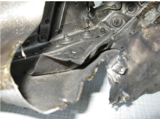
Rys. 32. Przekrój i wnętrze profilowanej owiewki (porównaj od Rys. 15 do Rys. 18 oraz Rys. 44). Osmalenia i trawa!
