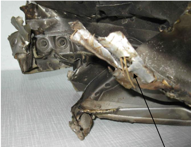
Rys. 37. Na pierwszym planie wystają z otworu po nicie resztki traw. Rozerwania, pocięcia, zniszczenia. W otworze trawa.
