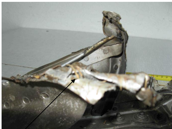
Rys. 43. Nienaturalne rozchylenie blach. Widoczne resztki traw.
