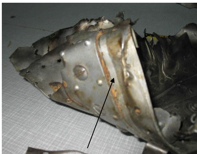
Rys. 48. Widoczne (brązowy kolor) przekładki tekturowe (!) pod złączeniem z licznymi nitami i śrubami. Wnętrze silnie osmalone, a z zewnątrz kolor srebrny.
