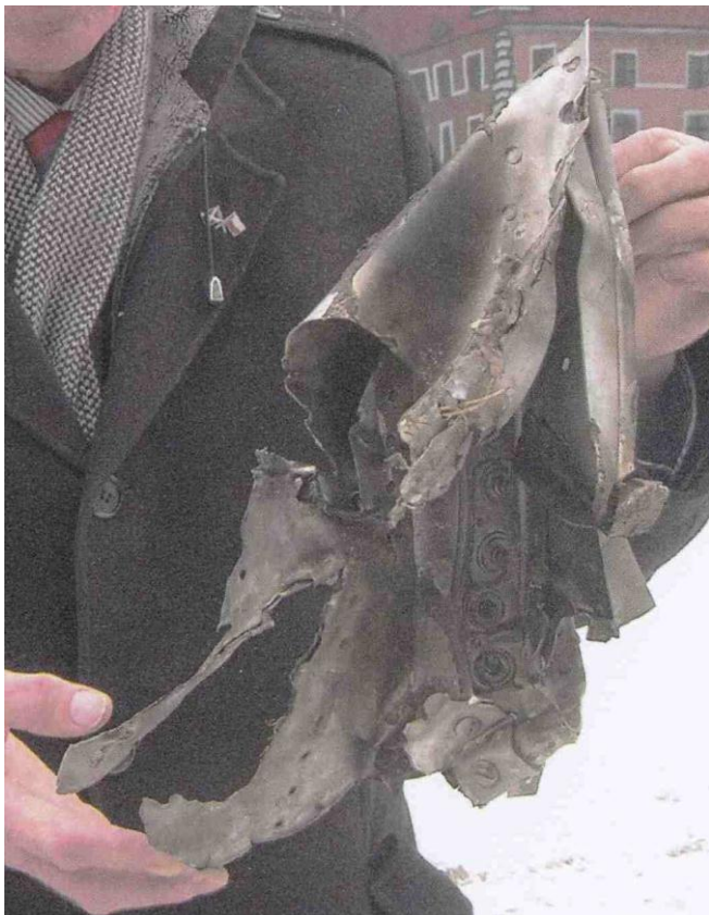
Rys. 2. Fotograf 2A. Porównanie wielkości elementu w stosunku do dłoni. Widoczne przebarwienia i ubytki zewnętrznej powłoki ochronnej blach.
