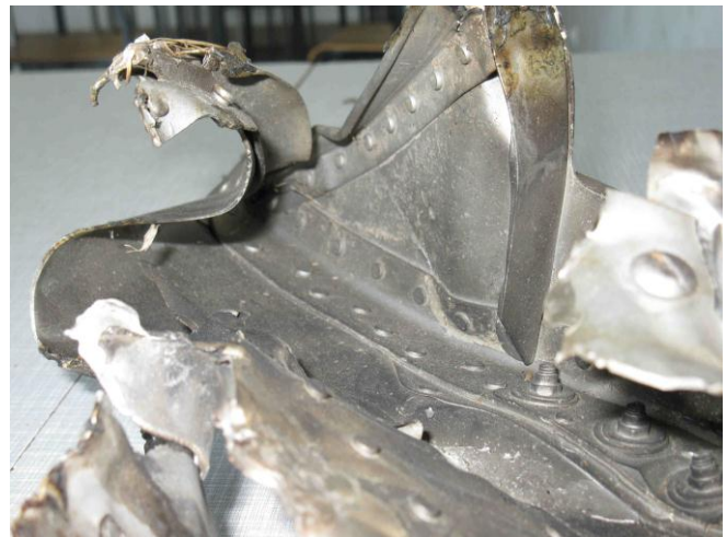
Rys. 29. Zdjęcie nawiązuje do Fotogramu 2A i do ujęcia z Rys. 26 – zbliżenie. Widoczne mocowanie żebra i oderwane oraz odgięte od niego poszycie.
