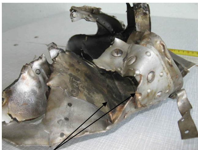
Rys. 47. Zdjęcie nawiązuje do Rys. 46 – zbliżenie. Widoczna tektura włożona pomiędzy znitowane blachy. Wnętrze silnie osmalone, a z zewnątrz kolor srebrny.
