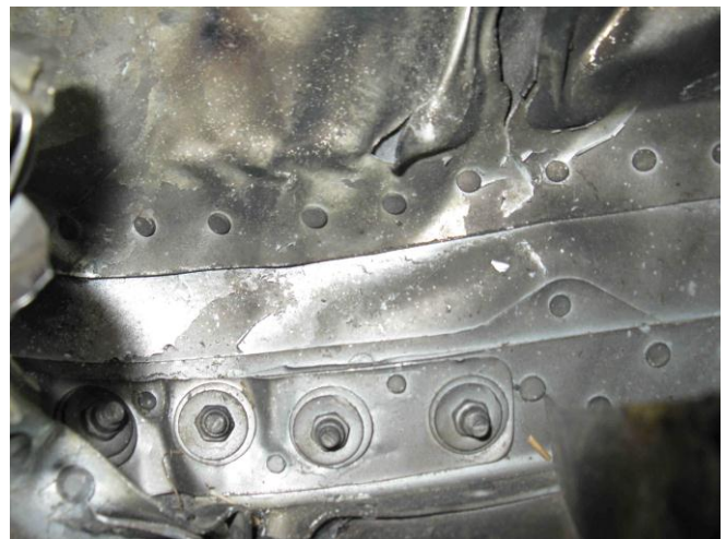
Rys. 23. Szczegół. Zdjęcie nawiązuje do Fotogramów 3A, 4A, 8A i do zdjęcia z Rys. 22 (odwrócone o 180°). Silne osmalenie.
