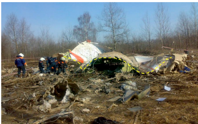
Rys. 3. Środkowa część kadłuba od wręgi 40 do 64 [5]. Rozerwanie wzdłuż kadłuba oraz wywinięte i wyrzucone na zewnątrz burty i sufit świadczą o potężnej eksplozji wewnątrz. Tego typu zniszczenie nie może być wywołane działaniem sił zewnętrznych.
