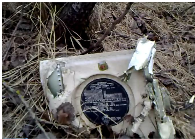
Rys. 19. Fragment amortyzatora podwozia głównego leżący między drzewami w strefie 4 [16].
