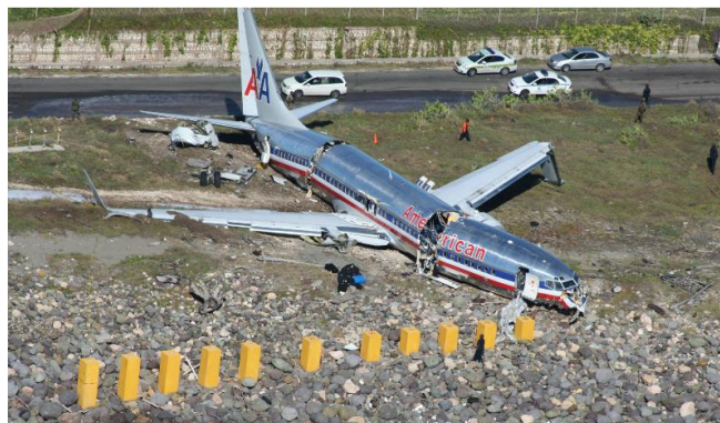
Rys. 7. Katastrofa Boeinga 737-800 w Kingston na Jamajce w dniu 22.12.2009. Katastrofa typu 1A – samolot uderzył w ziemię i nie było eksplozji.
