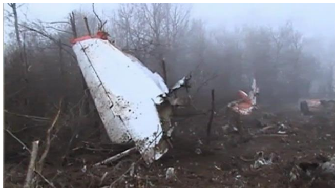
Rys. 22. Końcowa część prawego statecznika ze sterem wysokości. Widok dolnej powierzchni. Krawędź natarcia jest po prawej stronie. Dolna część statecznika ma fragment oderwany w kierunku lotu [18].
