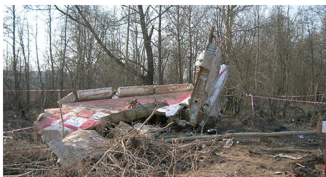
Rys. 23. Pozostałość statecznika pionowego i przyległe do niego fragmenty stateczników poziomych [6]. Brakujące części stateczników poziomych odpadły wcześniej.
